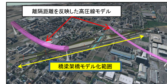
橋梁と架空線の離隔確認
