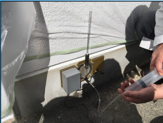
塗布前の現場透水量試験
