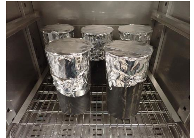
写真 4-1 ジオポリマー試験体作成状況
