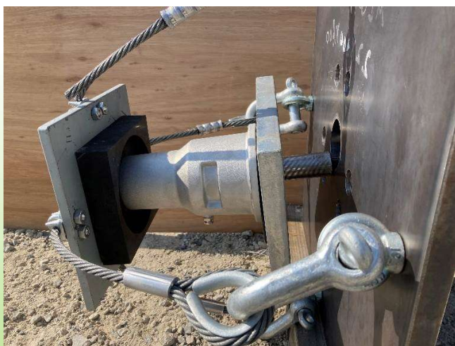
社内実験で飛び出し防止機能を確認
