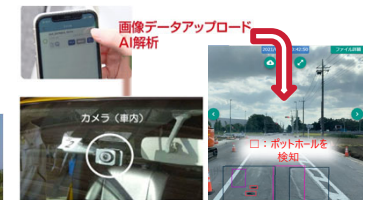
スマートフォンやドライブレコーダーによる舗装損傷検知
