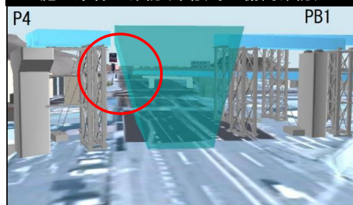
施工条件の確認（架設時の俯角確認）
