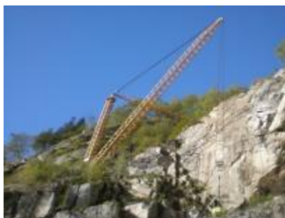
3.2tの重錘を32mの高さから落下
