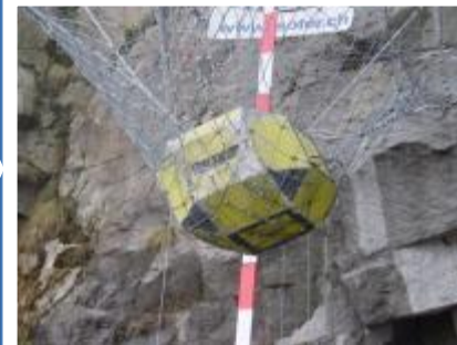
補修したネットで再度捕捉
