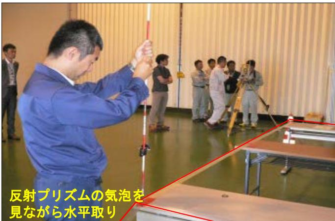
反射プリズムの気泡を見ながら水平取り
