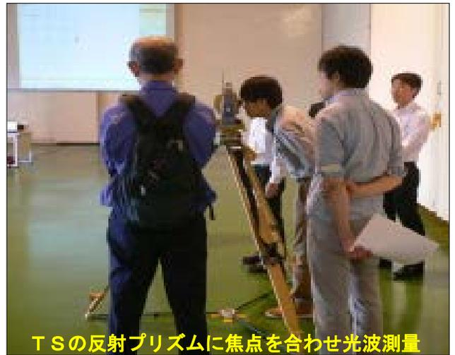
TSの反射プリズムに焦点を合わせ光波測量
